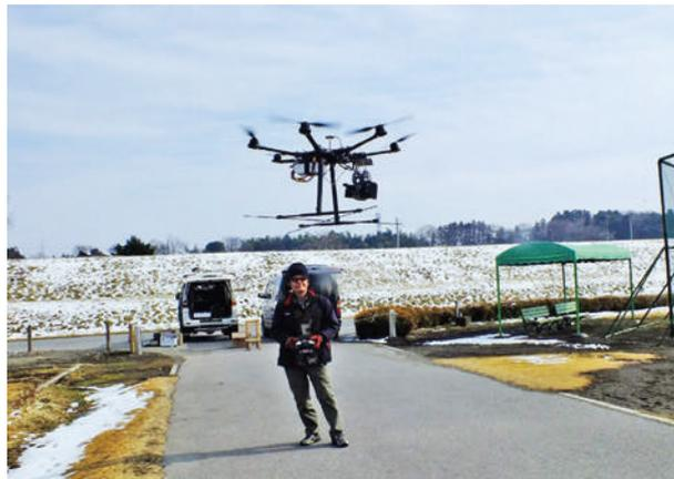
さらに、ドローンに全天球カメラを取り付けると 360 度の映像撮影は可能ですが、撮影漏れが無い事だけを目的とする全天球画像の撮影と、詳細な画像分析を伴う全天球画像の撮影では、そもそも画素数の問題からカメラの台数が異なります。1 台から 2 台の全天球カメラはファントム程度の機体でも搭載が可能になりましたが、詳細画像が必要な場合はカメラを数台から十数台搭載しますので、大型のドローンが必要になります。現在様々な調査にドローンの使用が検討されていますが、この基本条件を抑えておく必要があります。
